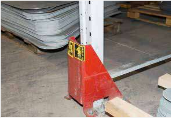
Şekil A.6.11: Kolon muhafazası örneği
