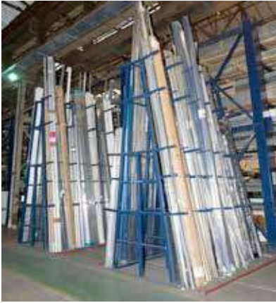
Şekil A.6.9: Uzun malzemelerin ayakta dikey raflarda depolanması
