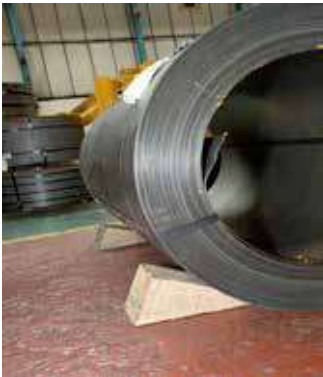
Şekil A.6.10: Silindirik malzemenin takozlarla sabitlenmesi
