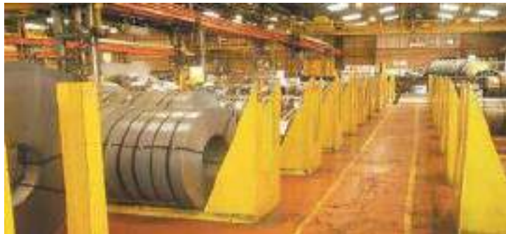
Şekil A.6.1: Bobin depolama alanında, yaya yollarının ve çalışma alanlarının zemin işaretlemesi
