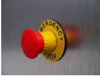
Şekil A.1.3: Makinalarda bulunan acil durum durdurma butonu örneği
